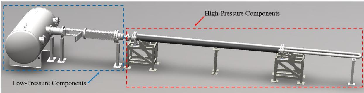
**Fig. 5: UTSA Mach 7 Ludwieg Tube Wind Tunnel**
